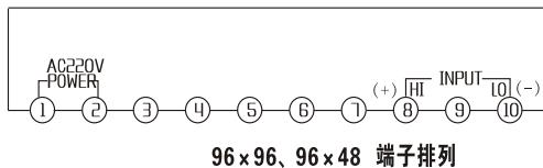
**POWER:** 仪表辅助电源(AC220V ± 10%)输入端口, 为其它值时应在订货时声明
